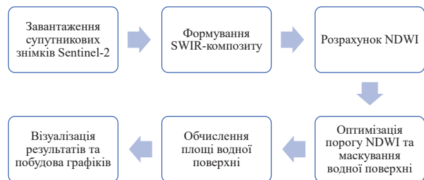
Рис. 4. Блок-схема методики дослідження динаміки водної поверхні озера Солончук-Тузли, за супутниковими даними Sentinel-2
